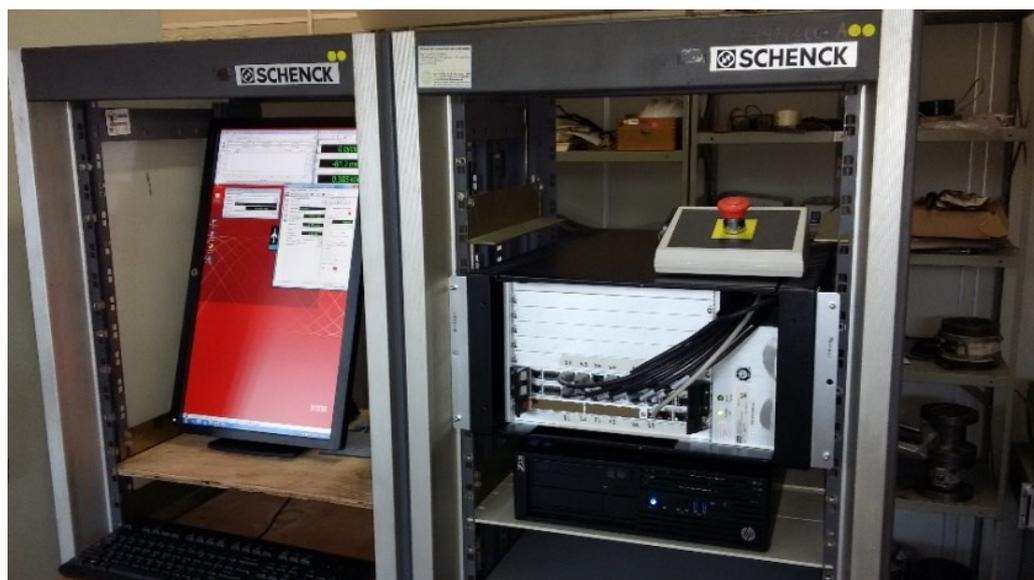
Figura 23 Controlador utilizado no ensaio do segundo Trilho. MTS FT 40.
