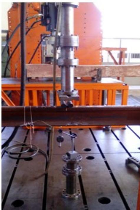
Figura 24 Medição da posição inicial do trilho TR57 (sem deformação) com o Relógio Comparador.
