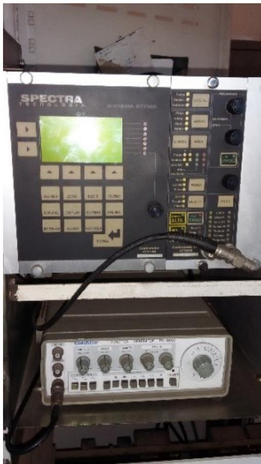
Figura 22 Controlador utilizado no ensaio do primeiro Trilho. Spectra ST 7000/ Gerador de sinal Goldstar.
